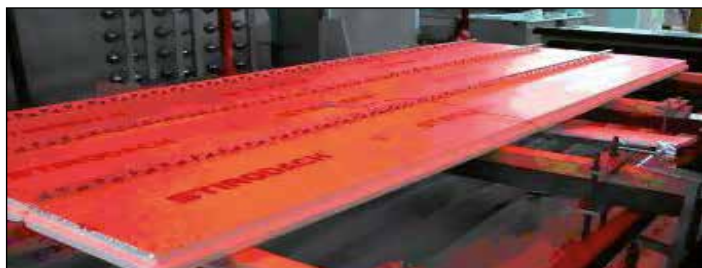
Prova di invecchiamento accelerato - Rel. Tecnica nr. 4263/RT/06 - Campione in assetto sperimentale durante la fase di irraggiamento a 60°C
