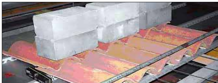
Prova di resistenza del profilo metallico portategole - Rel. Tecnica nr. 4290/RT/06 - Fase di carico di schiacciamento e trazione dei profili metallici
