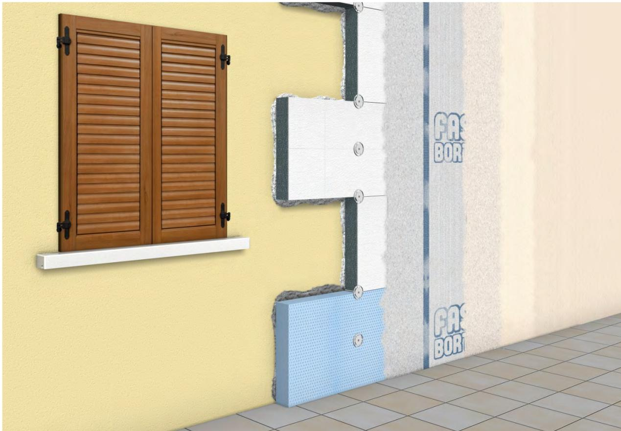
La Lastra per zoccolatura **Basetherm®** è un pannello in polistirene stampato. Le superfici presentano una goffratura ad incavi sottosquadra che ottimizza l'adesione del collante.
