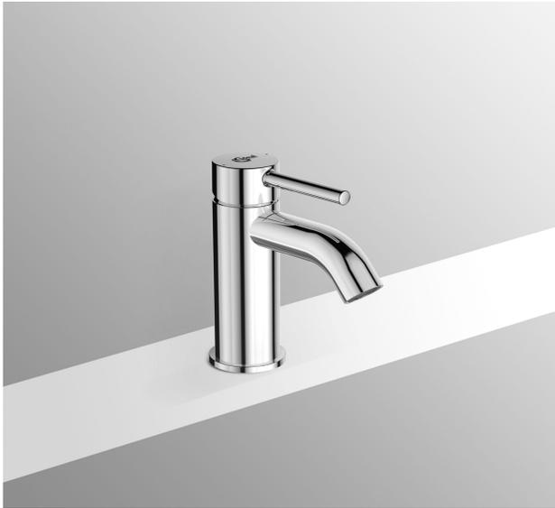
Miscelatore per lavabo con aeratore 5 l/m con bocca di erogazione fissa e aeratore nascosto, tubi flessibili. È dotato di cartuccia da 35 mm con limitatore della temperatura e riduttore di portata a 5 l/min. Sistema di fissaggio Easy Fix. Sporgenza bocca 100 mm, altezza della bocca 76 mm.
