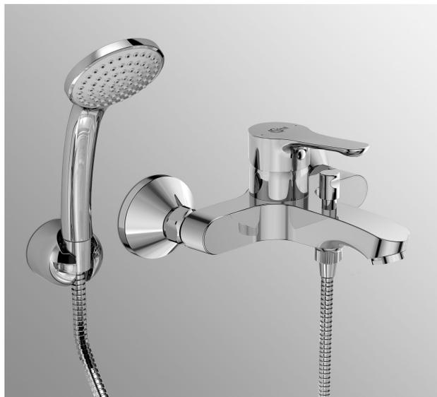
Miscelatore monocomando esterno per vasca/doccia. È dotato di raccordi ad S orientabili per interasse da 129 mm a 171 mm. Cartuccia da 35 mm con limitatore della temperatura. È corredato da doccetta a 1 funzione, supporto a muro e tubo flessibile da 1500 mm.
