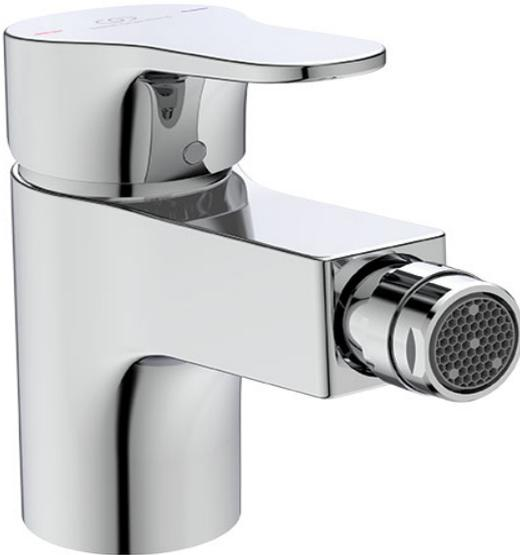
Con asta di comando e scarico piletta da 1-1/4" \*. Con bocca di erogazione fissa, rompigetto orientabile. Dotato di cartuccia FirmaFlow® da 38 mm con limitatore di temperatura. Sistema di fissaggio EasyFix. Tubi flessibili con attacco G3/8". Con asta di comando e scarico piletta da 1-1/4".
